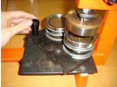
3. Dann legt man zuerst das silberne Button – Oberteil, dann die selbstgefertigte Papiervorlage (Aufdruck nach oben) und als oberste Lage die beigelegte Folie auf den linken Stempel der Schwenkplatte.
