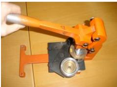
7. Die Button -Unterseite legt man dann - mit der geschlossenen Sicherheitsnadel nach unten - in den rechten Stempel.
