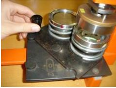
9. Den Ring mit den beiden Stiften so drehen, dass die Stützplatte zwischen den beiden Stiften ist (Nur Ring mit Stiften drehen siehe 5.).
