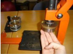
2. Die Schwenkplatte mit den zwei Stempeln legt man danach in die vorgesehene Aussparung und dreht diese bis zum Anschlag nach links.
