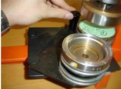
5. Drehen sie den Ring mit den beiden Stiften so, dass die Stifte unter der Stützplatte sind. Der Untere Teil des oberen Stempel darf sich nicht mitdrehen, halten sie ihn mit der anderen Hand fest sonst können sich die drei Lagen nicht richtig Verbinden.
